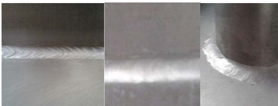
Slika 3. Izgled zavara eksperimentalnih limova i zavara nekih konstrukcija
