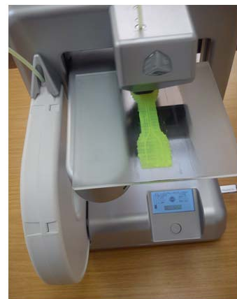
Slika 4. Printanje epruvete na Cube 3D printeru za ispitivanje zatezne čvrstoće
