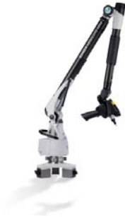
Slika 2: Mjerna ruka sa skenerom
