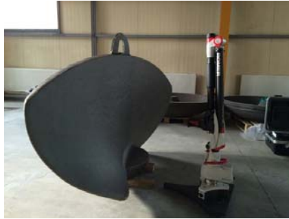
Slika 3: Odljevak lopatice pre početka mjerenja
