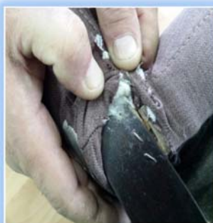
Slika 2: Deformacija nakon ispitivanja spoja zadnje noge stolice i sarga sjedišta
