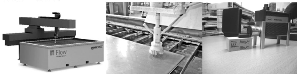
Slika 1. Postupak rezanja uzoraka, mašina Flow Mach 2 model 2031b i mjerenje hrapavosti površine na uređaju Perthometer M1
