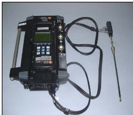
Slika 1. Analizator dimnih plinova TESTO 350 XL sa mjernim sondama [4].
