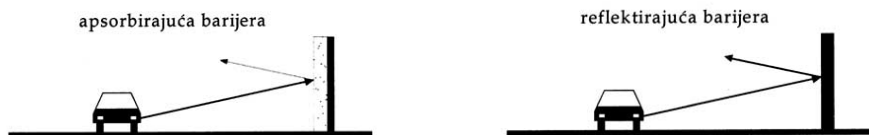
Slika 2. Osnovni tipovi barijera za zaštitu od buke
