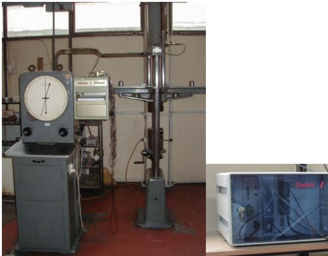
Slika 1. Kidalica 200 kN sa elektronskom jedinicom ZWICK
