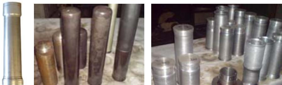
Slika 2. Primjer dijelova dobijenih postupkom rotacionim istiskivanjem u tvornici BNT-Novi Travnik
