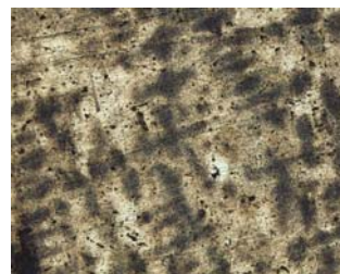
Slika 14. Uzorak 3 – 2: Izgled dendrita u centralnoj zoni, x50
