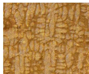
Slika 7. Uzorak 3 – 1: Izgled dendrita u centralnoj zoni, x50
