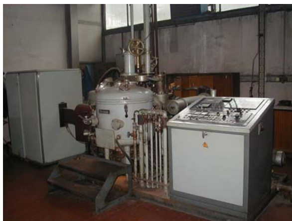
Slika 1. Vakuumska indukcijska peć (VIP) 20 kg (proizvođač Leybold Heraeus – Njemačka, tip IS 2/III)
