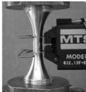
Slika 4. Deformacijom kontrolisani eksperiment (ASTM E 606)
