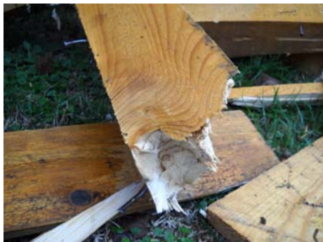
Slika 5. Totalna usukanost na građi drveta
