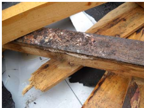
Slika 3. Građa napadnuta gljivama upotrebljena u bolnicu u Tetovu
