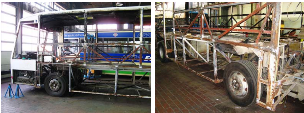
Slika 1. Rešetka autobusa koju treba izmjeriti
