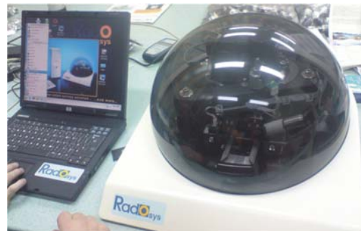
Slika 2. Sistem za automatsko mjerenje i brojanje urezanih tragova
