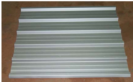
Slika 2. Uzorak trapeznog čeličnog lima dimenzija 1000 x 1060 x 0.6 mm
