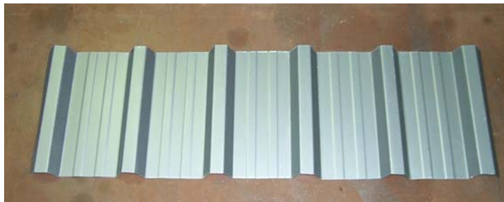
Slika 1. Uzorak trapeznog čeličnog lima dimenzija 300 x 1060 x 0.6 mm
