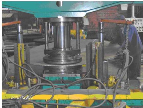
Slika 2. Postupak inkrementalnog presovanja
