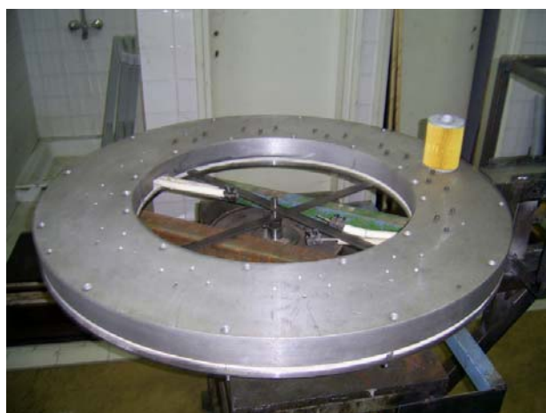
Slika 4. Kompletna ploča sa grijačima, izolacijom i keramikom
