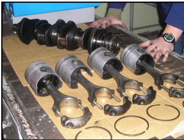
Slika 1. Ključni pomični sastavni dijelovi motora
