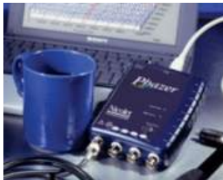
SLIKA1. PRENOSIVO MERNO POJAČALO ZA ANALIZU VIBRACIJA – PHAZER, NICOLET TECHNOLOGIES
